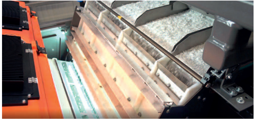
Flake Sortierer bei der sortenreinen Sortierung von Postconsumer-Kunststoffen
