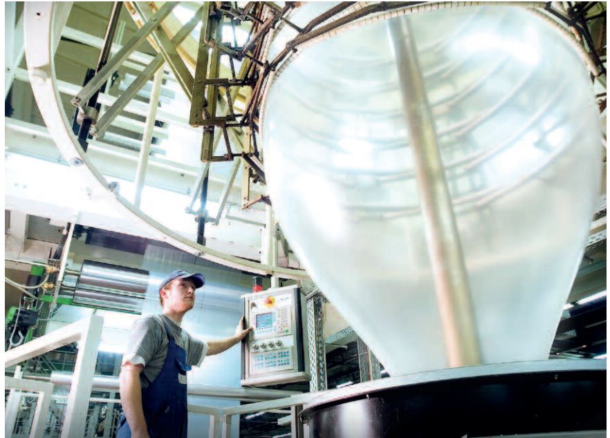
Die im Rahmen des RUBIO-Projekts entwickelten Biokunststofffolien aus PBS sind recyclingfähig, biologisch abbaubar und können auf gängigen Extrusionsanlagen verarbeitet werden (©POLIFILM)
